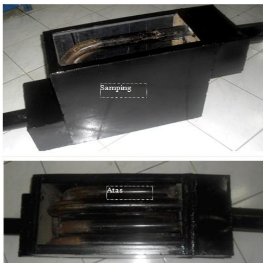
Gambar 10. Alat penukar kalor untuk mengalirkan udara bersih ke ruang pengering
