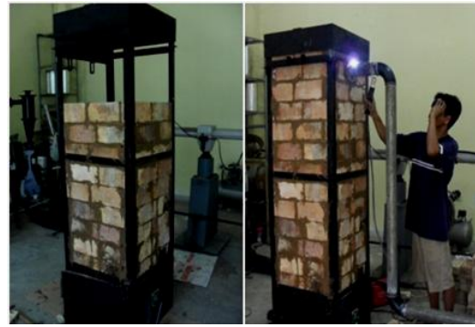
Gambar 7 .Pemasangan bata tahan api pada reaktor gasifikasi dengan semen tahan api dan sodium silikat sebagai pengikat
