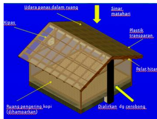
Gambar 1. Rancangan ruangan pengering yang dibuat berupa bangun yang terisolasi
