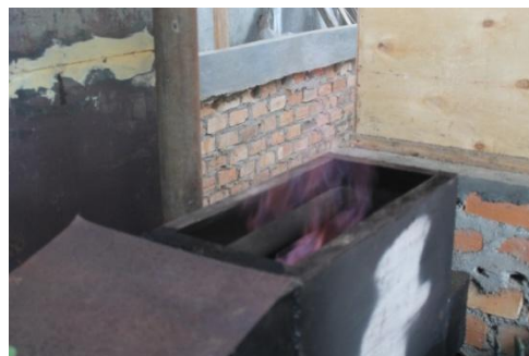
Gambar 9. Pengujian reaktor gasifikasi sehingga telah menghasilkan gas metan
