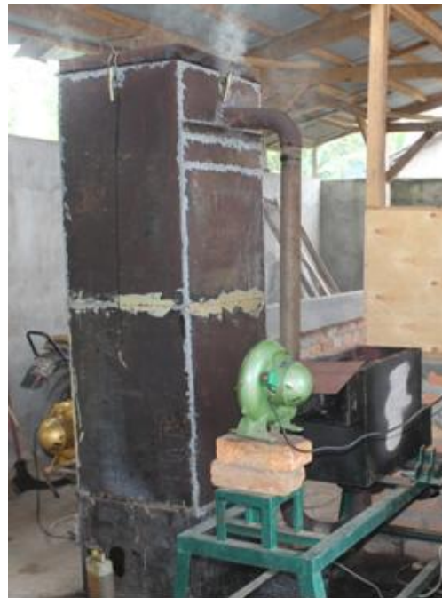
Gambar 8. Reaktor gasifikasi yang telah dipasang bata tahan api dan dibungkus dengan pelat setebal 1,5 mm
