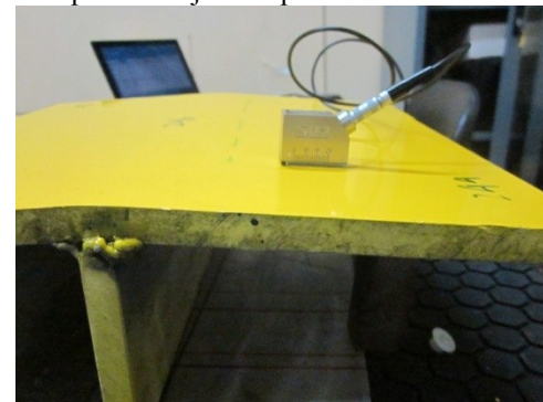
Gambar 3. Metode scanning pada material uji.
