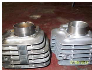
Gambar 2: Blok silinder sebelum dan setelah pemangkasan (kanan setelah pemangkasan)
