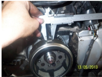
Gambar 4 : Pengukuran panjang reluktor magnet motor uji
