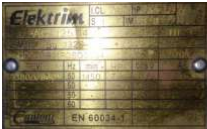
Gambar 3.3 Nameplate motor induksi 3 fasa
