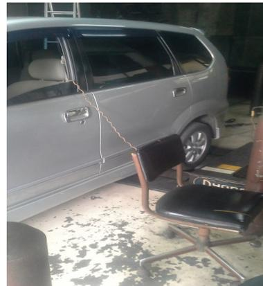
Gambar 3. Posisi roda belakang pada roller dynamometer
