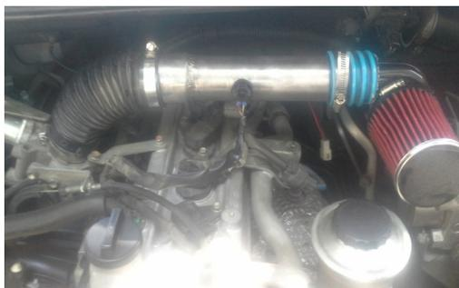
Gambar 2. Pemasangan supercharger elektrik pada ruang mesin avanza
