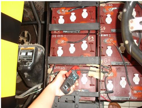
**Gambar 3. Pengukuran arus dengan tang amper**
