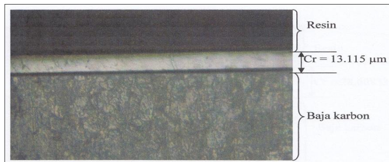
Gambar 3. Lapisan chromium pada rapat arus 15 A/dm^2
