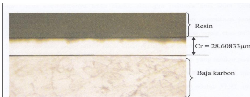
Gambar 6. Lapisan Chrome pada rapat arus 60 A/dm^2
