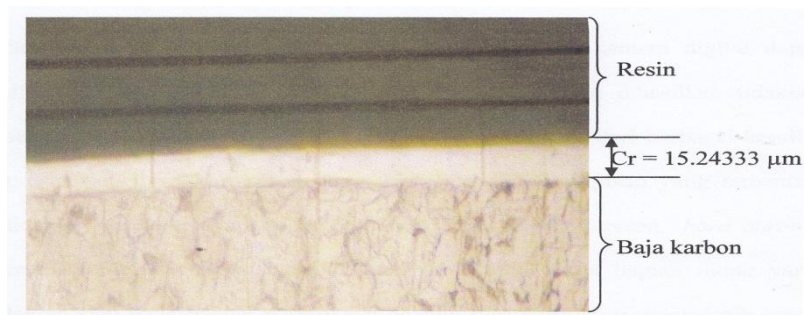
Gambar 4. Lapisan Chrome pada rapat arus 30 A/dm^2
