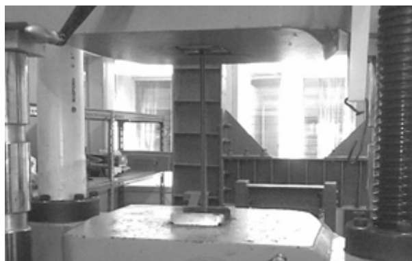
Gambar 8. Pengujian kuat tarik baut diameter 10 mm
