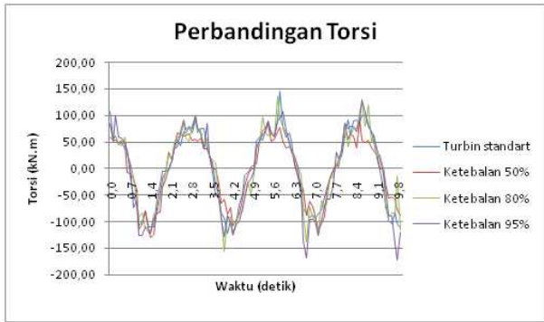
Gambar 9. Perbandingan Torsi pada Turbin Standart dengan Turbin Modifikasi ketebalan foil
