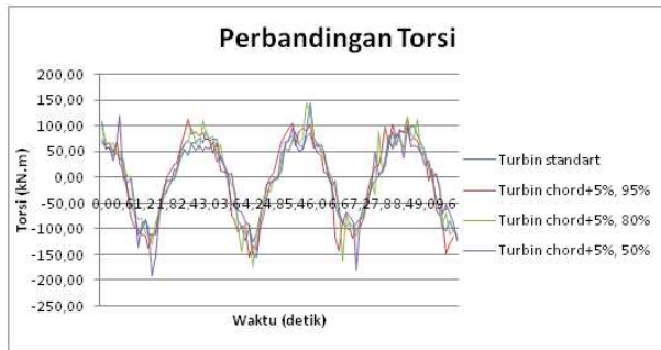
Gambar 10. Perbandingan Torsi pada Turbin Standart dengan Turbin Modifikasi kombinasi panjang chord 5% dengan ketebalan 95%, 80%, dan 50%
