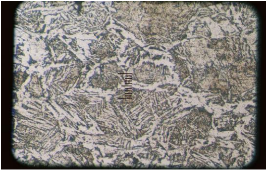
Struktur mikro bahan dengan heat treatment 600 0 C
