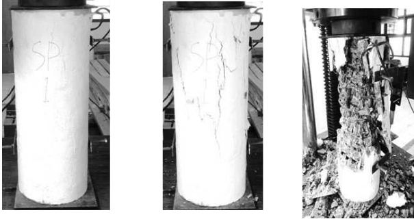
Gambar 7. Pola retak benda uji kolom lingkaran tulangan pengekan standar/spiral
