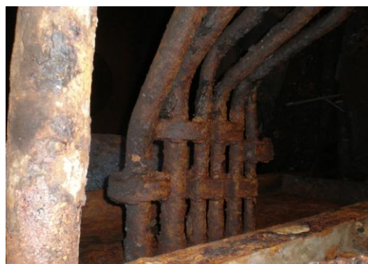
Gambar.1. Korosi Seragam pada pipa ballast
