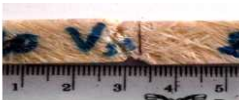
Gambar 15 Foto makro spesimen dengan fraksi volume 20%
