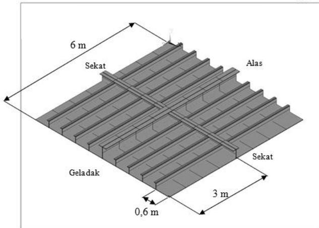
Gambar 1. Model pelat dengan *finite element software*.
