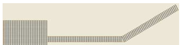
Gambar 13. Domain dan mesh simulasi model saluran dengan bentuk L (L-Shape) dengan sudut 45°
