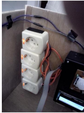
Gambar 14 kondisi saat relay on kemudian setelah 3 detik maka relay akan “OFF” selama 3 detik dan lampu pada stop kontak akan mati seperti yang ditunjukkan gambar 15 keadaan akan berulang terus relay ON dan OFF dengan selang waktu 3 detik.
