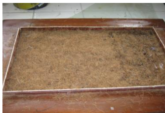
Gambar 11. Peletakan Serabut Secara Acak
