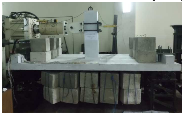
Gambar 3. Setup dan pembebanan benda uji
