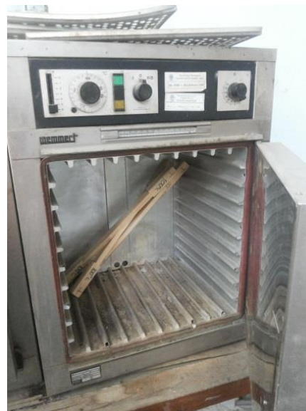
Gambar 1. Proses Pengeringan Laminasi Bambu Menggunakan Oven
