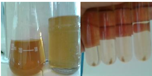
Gambar 6. Proses pengendapan pektin dengan dan tanpa penambahan asam (kanan ke kiri), serta hasil pektin setelah proses sentrifugasi (atas dengan asam, bawah tanpa asam)
