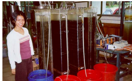
Gambar 2. Reaktor Nitrifikasi dan Denitrifikasi yang digunakan Untuk Percobaan.
