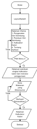
Gambar 7. Diagram Alir tampilan kalkulator kalori Diagram Alir aplikasi untuk menu Tentang Aplikasi ditunjukkan pada Gambar 8.
