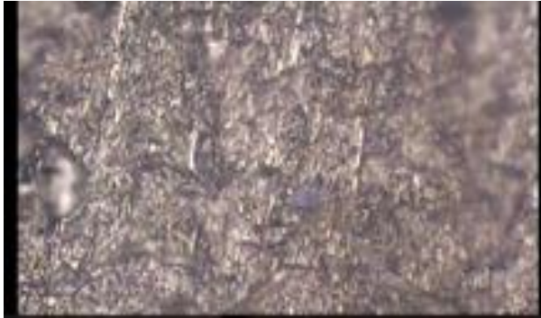
Gambar 14. Sampel 4 Sesudah Dikorosi Kering pada Suhu ≈ 27°C
