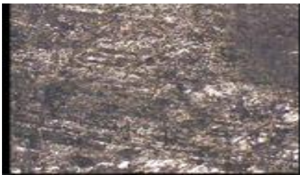
Gambar 10. Sampel 4 Sesudah Dikorosi Larutan pH 7
