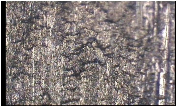
Gambar 15. Sampel 4 Sesudah Dikorosi Kering pada suhu 100°C
