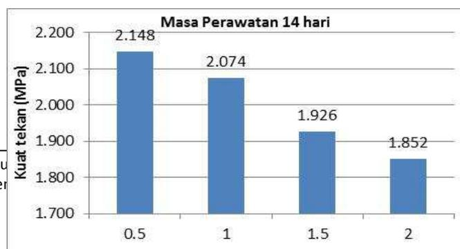
Gambar 5. Grafik Hubungan Kuat Tekan Terhadap Variasi Diameter Pipa Outlet dalam Campuran Bata Ringan CLC Pada Umur 14 Hari
