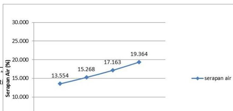
*Gambar 10. Grafik Hubungan Antara Serapan Air Terhadap Variasi Diameter Pipa dalam Campuran Bata Ringan CLC pada Umur 56 Hari*
