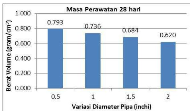
Gambar 2. Grafik Hubungan Berat Volume Terhadap Variasi Diameter Pipa Outlet dalam Campuran Bata Ringan CLC pada Umur 28 Hari
