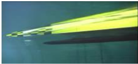
Gambar 11. Tekanan udara P=0.0 bar pada Fr=0.88
