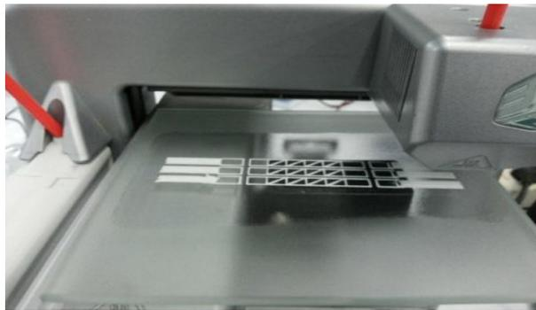
**Gambar 9.** *Support* Spesimen Orientasi Vertikal Bahan PLA
