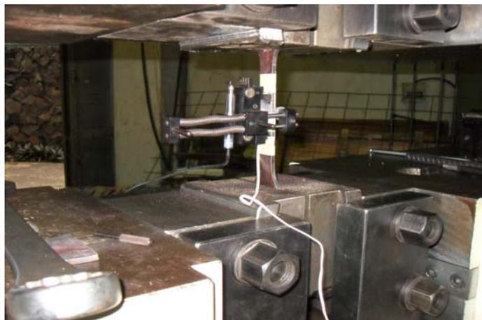
(a) Mesin uji tarik baja (UTM) dan posisi penempatan benda uji (posisi ellips)
