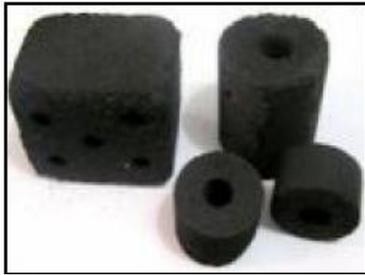
Gambar 1. Arang Briket dari Tempurung Kelapa
