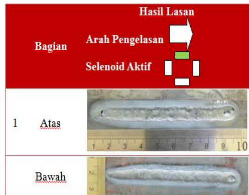
b. Arus= 70 A, Kecepatan Pengelasan= 1,5 mm/s, Aliran Gas Argon = 3 l/min, Ada Solenoid Posisi 90°, Kondisi Statis
