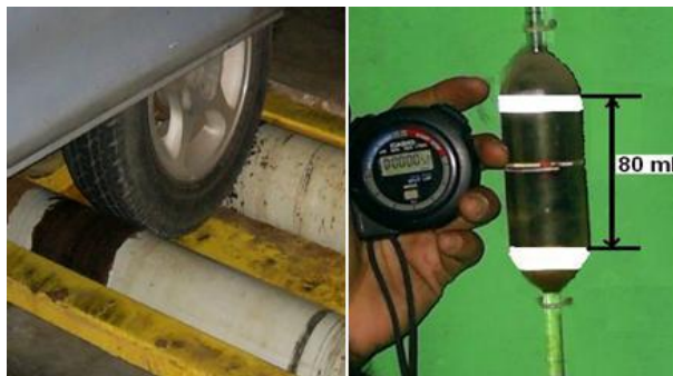
Gambar 7. Proses Uji Daya dan Konsumsi Bahan Bakar Mobil Berbahan Bakar Bensin dengan Kapasitas 1300 cc
