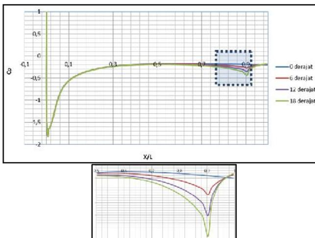
Gambar 5. Grafik distribusi  $C_p$  di *upperside* midspan bodi standar dan modifikasi (3D-flow)
