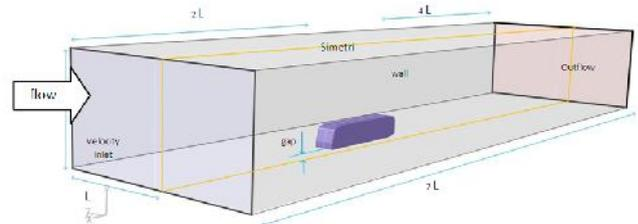
Gambar 2. Domain dari pemodelan 3D yang digunakan
