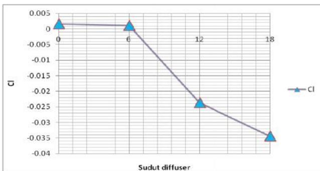
Gambar 10. Grafik Cl pada masing-masing variasi sudut
