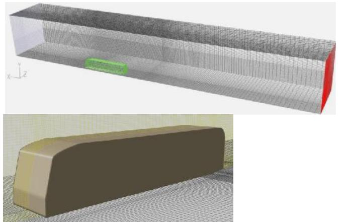
Gambar 3. Bentuk meshing pemodelan 3D
