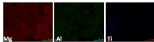
Gambar 9 (a) Hasil EDX dari sampel hasil milling 933rpm (b) Hasil mapping dari sampel hasil milling 933rpm-20% Al_3Ti
