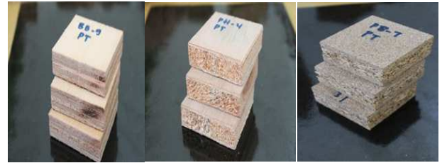
Gambar 2. Contoh uji papan komposit komersial plywood (A), papan blok (B) dan papan partikel (C)
