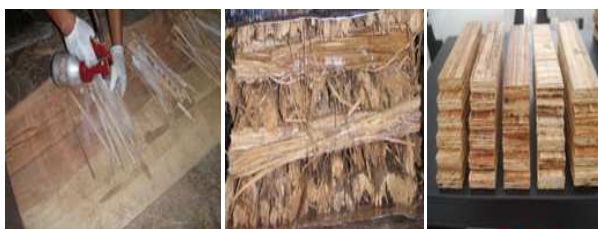
Gambar 1. Proses pemberian bahan perekat, penyusunan lembaran zephyr dan sampel uji papan zephyr pelepah sawit
