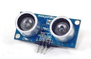
Gambar 3 Contoh Sensor Ultrasonik
