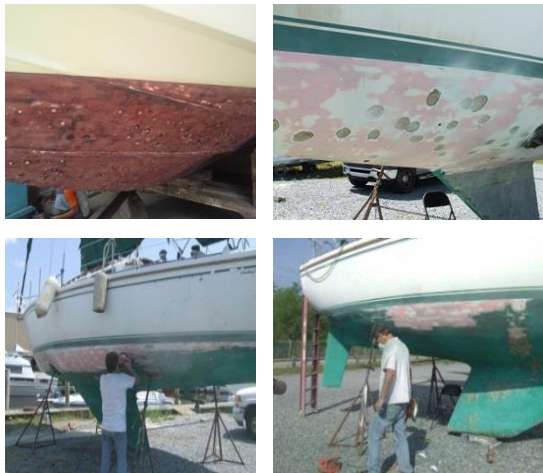
Gambar 13. Kondisi blistering dan perawatan zona lambung kapal fiber glass
