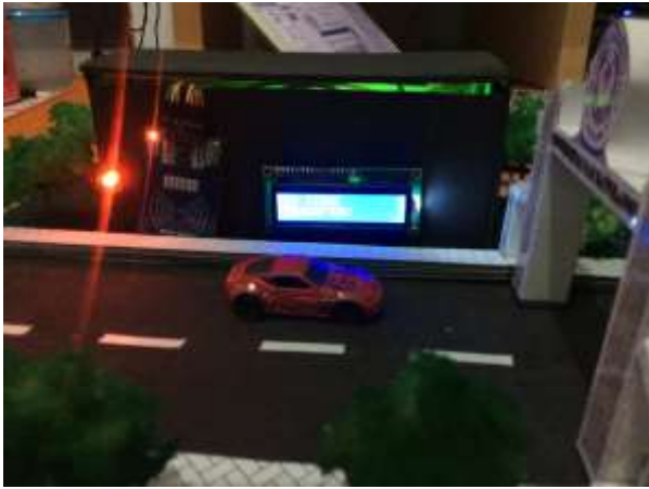
Gambar 20. Respon LCD, LED, dan Buzzer atas ID tidak terdaftar.
