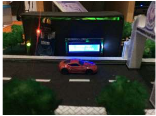
Gambar 18. Respon LCD, LED, dan Buzzer atas ID terdaftar.
