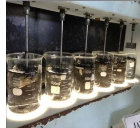
Gambar 1 Rangkaian Percobaan Batch Sumber: dokumentasi pribadi, 2013
