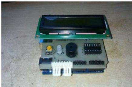
Gambar 9 Rangkaian output terdiri dari LCD,LED,Buzzer.
