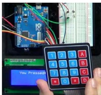
Gambar 14 Rangkaian pengujian keypad
