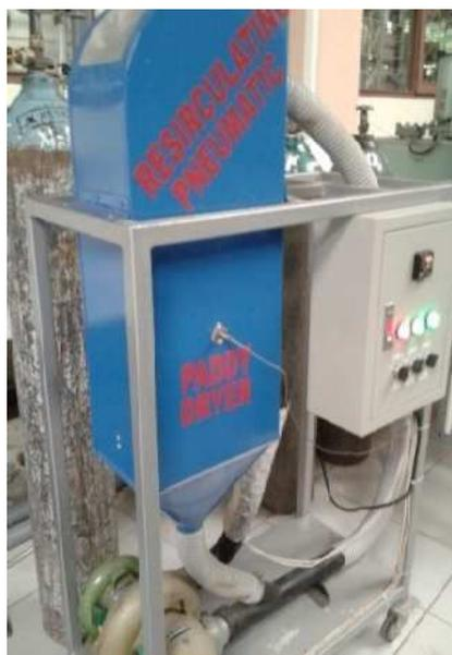
Gambar 1. Rangkaian Alat Pengering Gabah Resirkulasi Kontinyu tipe Konveyor Pneumatik
