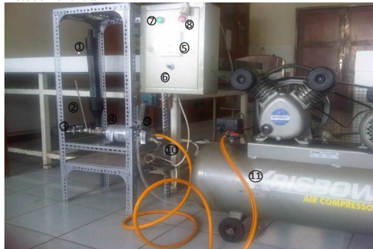
Gambar. 1 Alat Unggun terfluidisasi. (1) kolom unggun terfluidisasi, (2) termometer, (3) kran bukaan pengatur flow rate, (4) heater, (5) indikator suhu pemanas, (6) termostat, (7) saklar on, (8) saklar off, (9) flow meter, (10) selang pengalir udara, (11) kompressor
