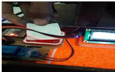
Gambar 8. NFC tag didekatkan pada reader
