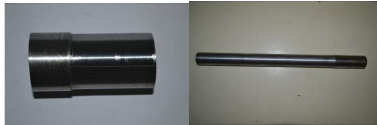
Gambar 1. Spesimen Uji Baja St 40
