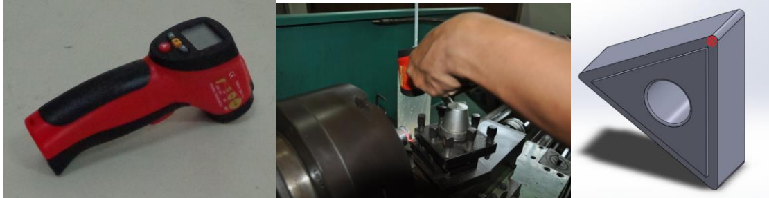
Gambar 4. Infrared thermometer dan titik penembakkan infrared thermometer
