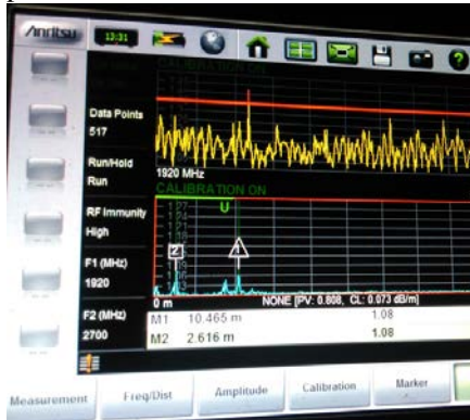
Gambar 16 Pengukuran Nilai VSWR setelah Troubleshooting
