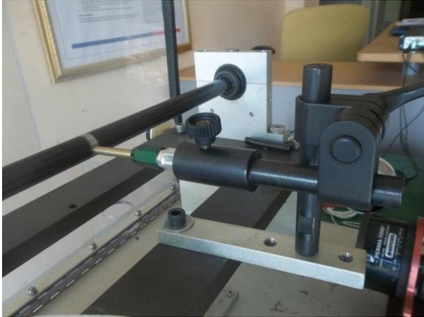
Gambar 2. Pemasangan *Mechanical Rub Kit* pada MFS
