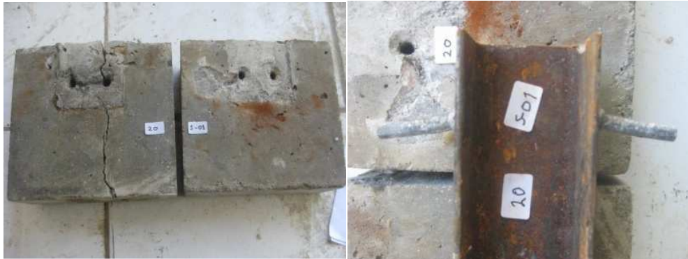
Gambar 3. Kegagalan spesimen 17 S- 01
