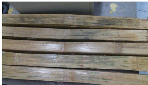
Gambar 4.11. spesimen setelah di uji lentur
