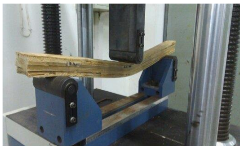
Gambar 4.8. Proses Pengujian lentur
