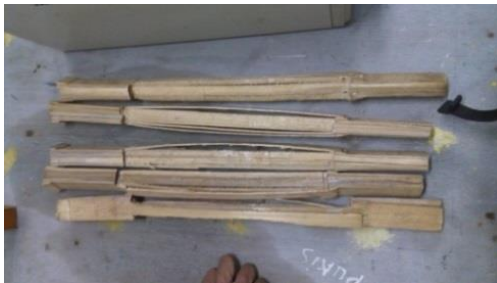
Gambar 4.7. Spesimen setelah di uji Tarik
