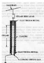
Gambar 1. Elemen-elemen arrester jenis ekspulsi atau tabung.
