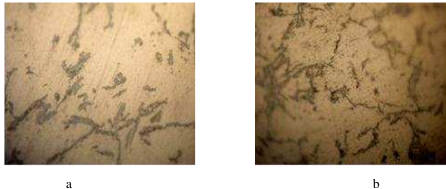
Gambar 12 a) Hasil uji mikrografi AlSi tanpa menggunakan AlTiB dan SiC 0% perbesaran 200x [14] b) Hasil uji mikrografi AlSi dengan menggunakan AlTiB perbesaran 200x.
