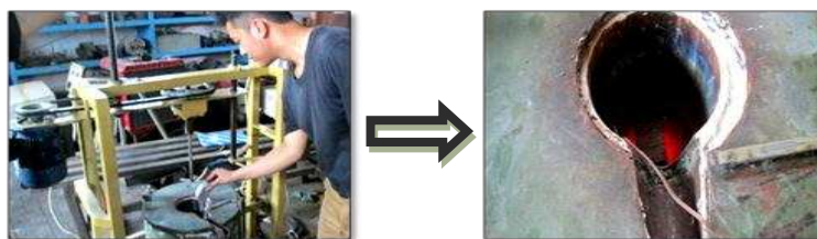
Gambar 2. Proses peleburan dengan tungku induksi.
