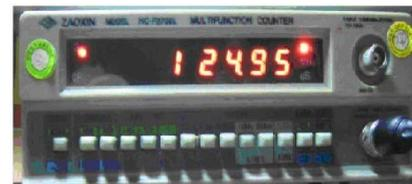
**Gambar 4.1** Hasil Pengujian Frekuensi RFID
