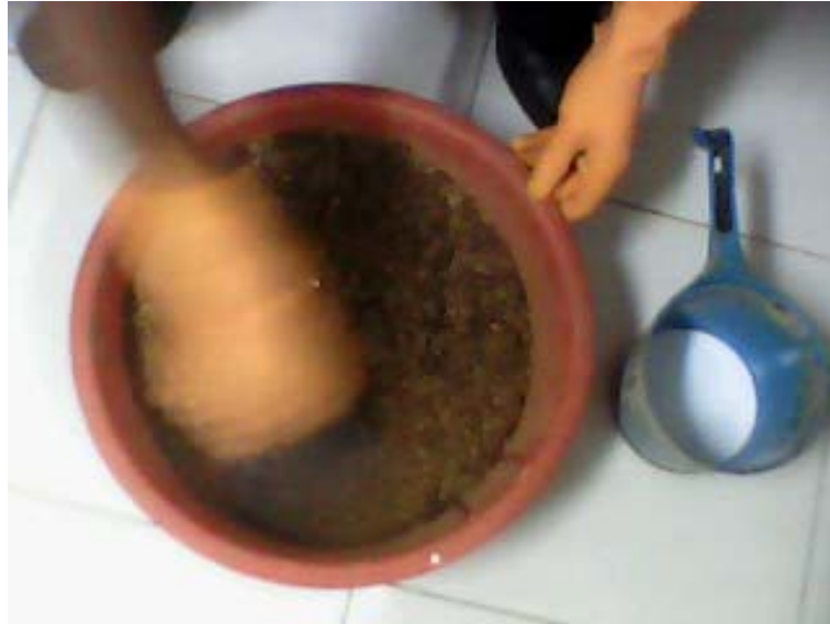
Gambar 3.1 Pencampuran Tanah dan Soil Binder .
