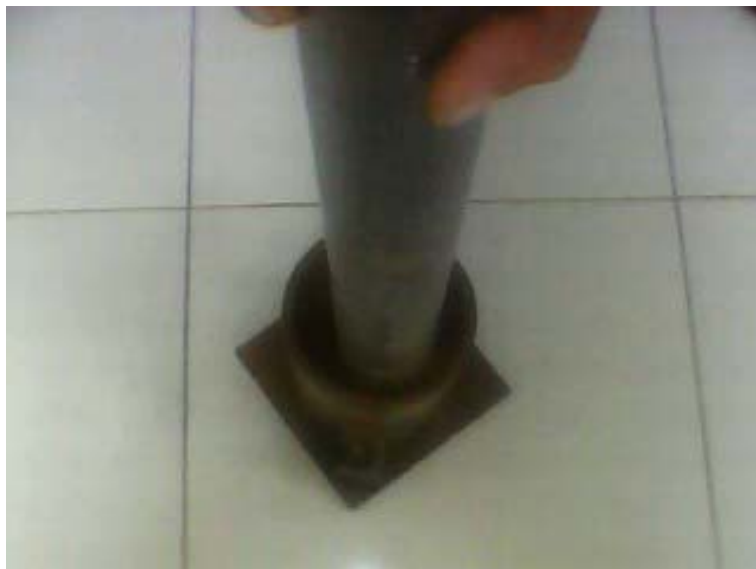
Gambar 3.2 Pemadatan campuran tanah & Soil binder .
